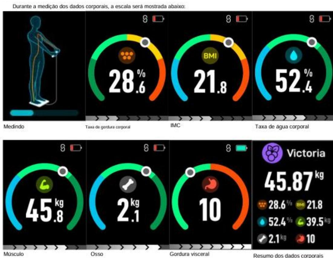
Nota: Por favor, não desça da balança e solte a barra (a medição demora cerca de 15 segundos).
