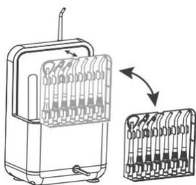
A caixa de armazenamento do bocal pode ser removida puxando a fivela. Por favor, faça isso com cuidado para evitar danos. Você pode retirar um bico da caixa antes da lavagem ou posicionar a caixa ao lado do fio de água para uma troca de bico mais conveniente.
