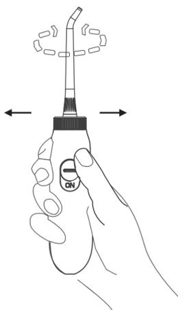
Aponte o jato diretamente entre os dentes. Ative o aparelho e ajuste a pressão conforme desejado (na primeira utilização, é aconselhável começar com a pressão mínima). Pressione o botão para escolher o modo "Normal/Suave/Pulso". A direção do jato de água pode ser controlada girando o botão superior do "manipulador" em 360 graus.
